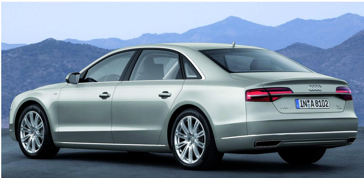
**Beim aufgefrischten A8 bleiben die Außenmaße unverändert (5,14 m Länge, 2,99 m Radstand, 1,95 m Breite und 1,46 m Höhe). Ebenso kommen beim langen A8 (im Bild das Topmodell W12 quattro) bei Radstand und Länge wie gehabt je 13 cm dazu. Bei beiden Karosserievarianten soll sich der Gepäckraum durch einen geänderten Zuschnitt besser beladen lassen. Insgesamt stehen zwölf Lackfarben zur Wahl, darunter fünf neue. Das Angebot an Rädern reicht bis zu 21 Zoll**
