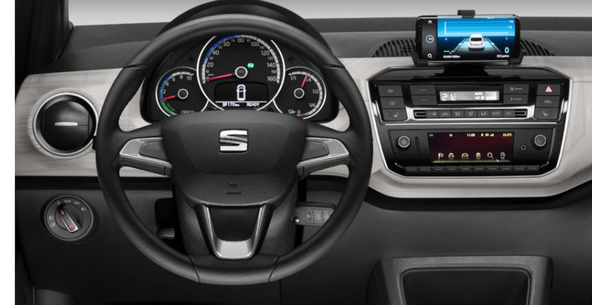
Schlicht, aber übersichtlich und leicht zu bedienen – das Cockpit des Mii electric. Statt eines Monitors gibt's eine Halterung fürs eigene Smartphone samt ideal platzierter Belüftung dahinter. Eine praktikable Lösung, zumal aus der Ferne über eine App z.B. vorklimatisiert oder der Akku-Zustand gecheckt werden kann.
