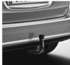
Anhängervorrichtung mechanisch abklappbar
