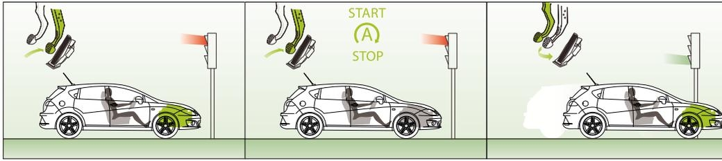
Wenn das Fahrzeug angehalten wird, der Leerlauf eingelegt wird und das Kupplungspedal losgelassen wird, schaltet das Start-Stop System den Motor ab. Sobald die Kupplung wieder betätigt wird, startet der Motor automatisch.
