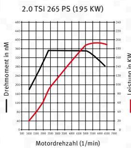
Die Benzinvarianten reichen von 1.4 85 PS (63 kW) bis zum erstaunlichen 2.0 TSI 265 PS (195 kW) des Cupra R.
