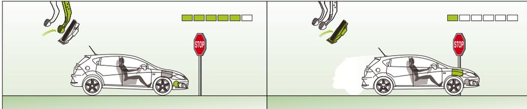
Ein Energie-Rückgewinnsystem (Rekuperation) steuert auf intelligente Weise die Lichtmaschine, um Energie rückzugewinnen und während der Beschleunigung wieder in das System einzuspeisen. Dieses System trägt dazu bei, während der Fahrt den Treibstoffverbrauch zu reduzieren und als Folge davon die CO<sub>2</sub>-Emissionen zu senken.
