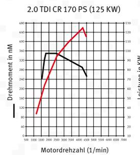
Alle Dieselmotoren sind mit einem Dieselpartikel-filter ausgerüstet. Common-Rail Technik macht den Motor lauffruhiger, geräuschärmer und effizienter.
