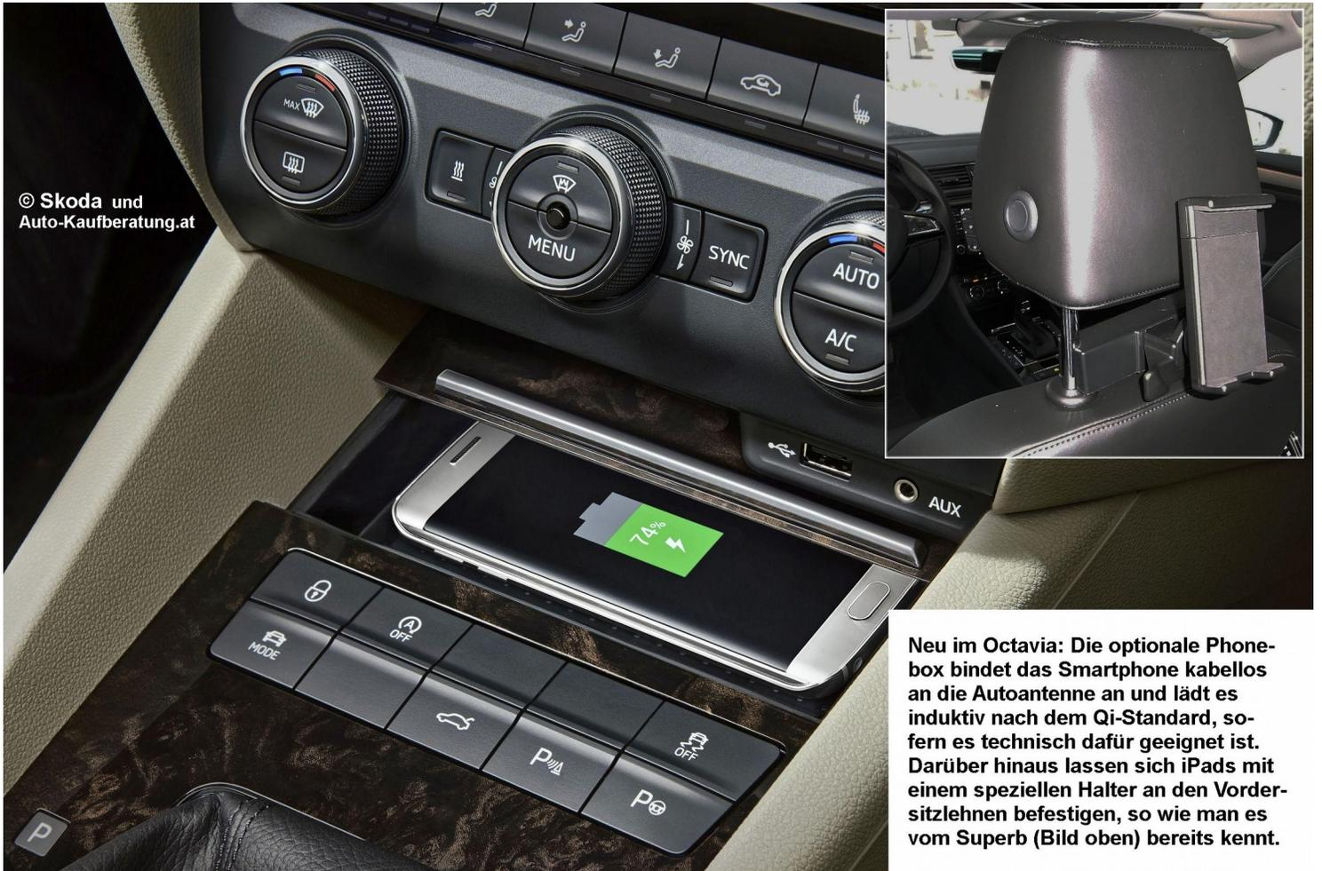
Neu im Octavia: Die optionale Phone-box bindet das Smartphone kabellos an die Autoantenne an und lädt es induktiv nach dem Qi-Standard, sofern es technisch dafür geeignet ist. Darüber hinaus lassen sich iPads mit einem speziellen Halter an den Vordersitzlehnen befestigen, so wie man es vom Superb (Bild oben) bereits kennt.
