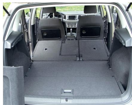
Für Variabilität sorgen konventionelle, aber wie geschmiert funktionierende Mechanismen. Der Laderaum fasst mindestens 500, maximal 1.520 Liter
