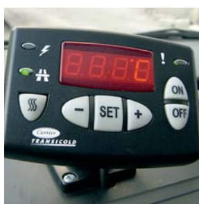
Multifunktions-Kabinensteuerung: Vom Cockpit aus können sämtliche Steuerungen vorgenommen werden wie Ausschalten, automatisches Starten im Straßenbetrieb, Setpunkt-Einstellung und Abtauen
