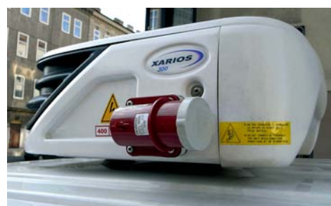
Standkühlung: Praktisch z.B. für Cateringdienste im Freien ist das Kabel (hier unter dem Beifahrer-Doppelsitz) zum direkten Stromanschluss ans Kühlaggregat. Stefan Schweinberger: „So sind die Lebensmittel gekühlt, ohne dass der Dieselmotor stundenlang rennt“
