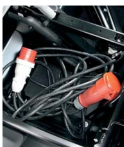
Standkühlung: Praktisch z.B. für Cateringdienste im Freien ist das Kabel (hier unter dem Beifahrer-Doppelsitz) zum direkten Stromanschluss ans Kühlaggregat. Stefan Schweinberger: „So sind die Lebensmittel gekühlt, ohne dass der Dieselmotor stundenlang rennt“
